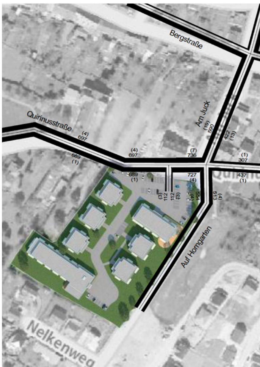
Streckenbelastungen Prognose; Modellbelastungen Kfz/d (SV-Fz/d); Quelle: V-KON S.à.r.l., Stand November 2016
